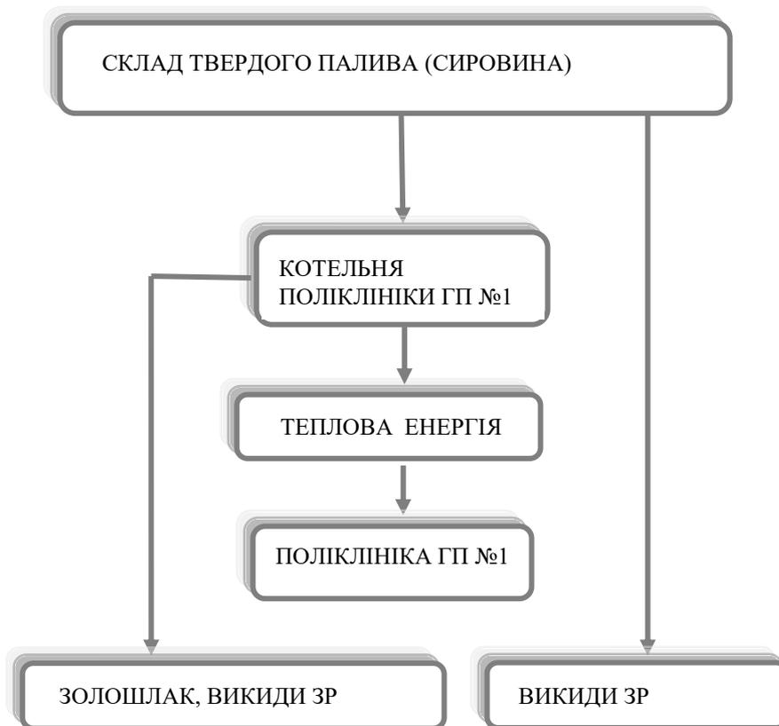
Мал.3 Блок-схема виробничого процесу на проммайданчику в/м №58
